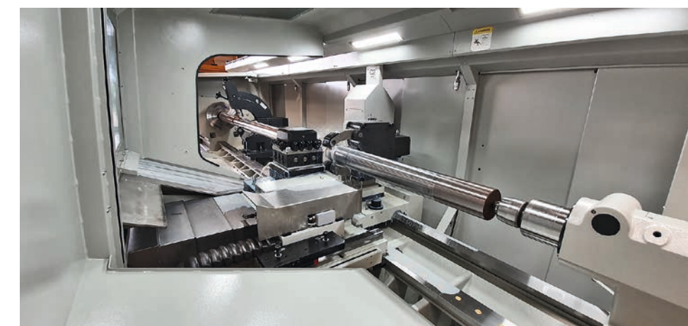
Bei Vier-Bahnen-Drehmaschinen kann der Schlitten die Lünetten und den Reitstock überfahren, sodass lange Bauteile meist in einer Aufspannung bearbeitet werden können.
